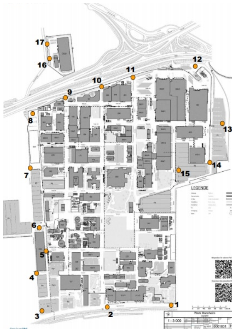
Abbildung 5.12: Werkplan mit Lärmpegel Messstellen.
